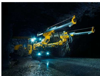
Boomer M20 är världens första ortdrivningsaggregat som har skyddad hydraulik, elektronik och sensorer.
